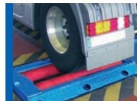
Ausführung und Leistungsprofil identisch mit TCS Basic, jedoch mit erweitertem Lieferumfang: Anstelle des Näherungsschalters ist die Semmler-Rolle integriert. Dadurch ist keine Straßenvergleichsmessung nötig, was eine erhebliche Zeitersparnis bedeutet.
