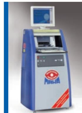
Dient in Verbindung mit dem Bremsprüfstand IW 4/7 oder dem Tachoprüfstand TPS zur Ermittlung der Wegdrehzahl und der Wegimpulszahl für alle mechanischen und
